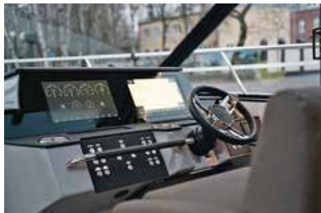
Förarplatsen är väl disponerad. Standard är en 12-tums plotter, men testbåten hade två plottrar.
