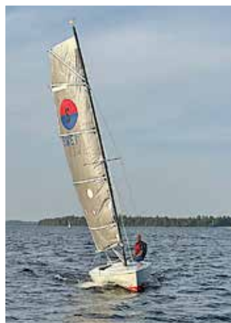
En modifierad 606 S under segel i 5 m/sek. Balansen blev bra med 70 cm mastlutning. Efter ny inmätning fick 606S SRS-tal 0,751.
