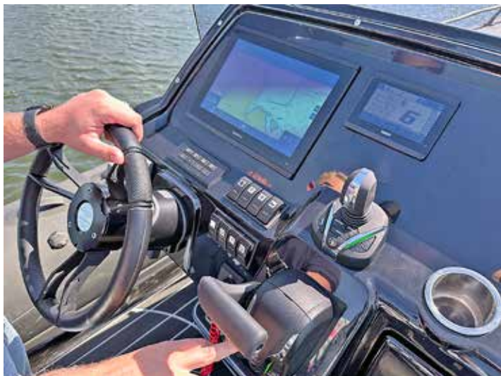
Full integration mellan joystick, kartplotter och motor i Yamaha Helm Master AX. Autopiloten sköts via plottern och knapparna till vänster i bild. Joysticken har fem olika lägen för hur mycket gas den ger.
