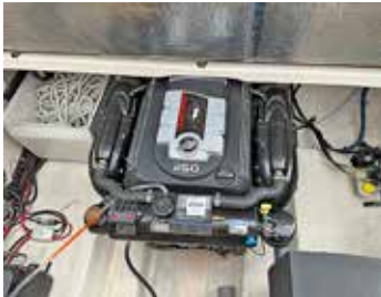
MerCruiser V6 bensinmotor på 250 hk och Bravo 3.
