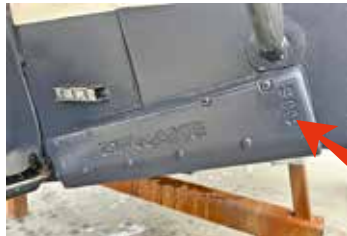
Zipwake interceptorer ger ett bättre gångläge och ökad kontroll jämfört med Nimbus original trimplan.
