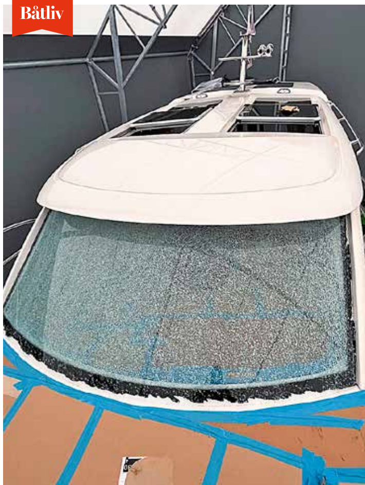
Den här nästan nya Nimbusen fick framrutan helt förstörd när en segelbåt välte på en uppställningsplats i båtklubben.
