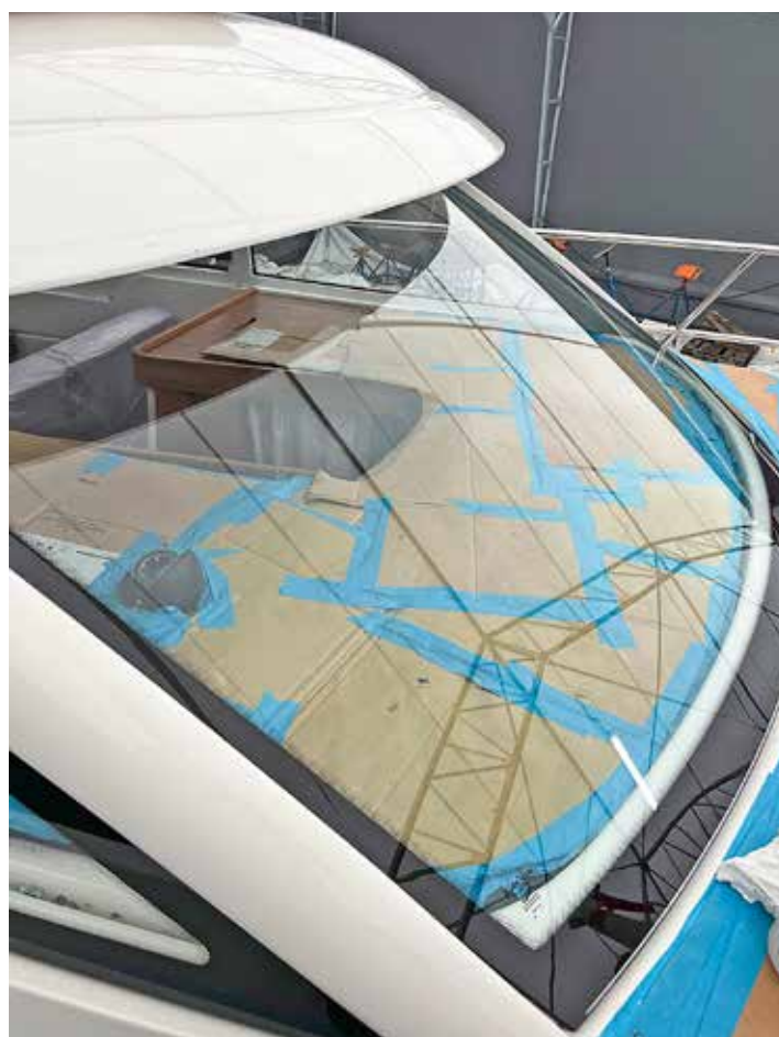
Samma Nimbus 305 med en ny ruta som är måttanpassad och monterad enligt Strigin Säkerhetsglas metod.
