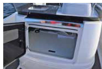
Stort och djupt fack i styrepulpeten. Här finns en inspektionslucka för koll av båtens undre delar.
