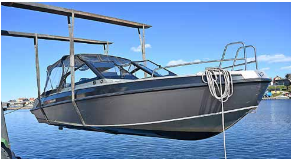
Båtlivs Buster SuperMagnum sjösätts målad med silikonfärgen International B-Free Explore. Det är en silikonfärg som ska ge mindre beväxning och förhoppningsvis även lägre bränsleförbrukning.
