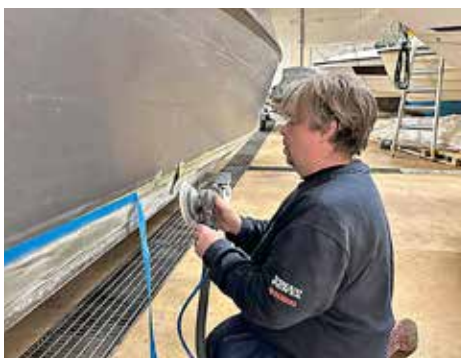
Slipning av den gamla bottenfärgen.
