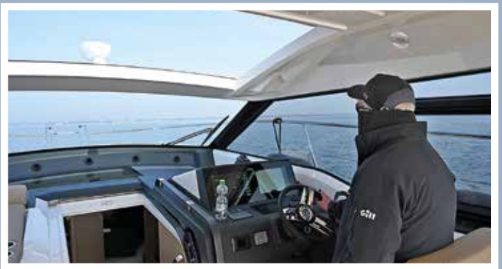
Förarplatsen är väl disponerad. Testbåten hade tillvalen 2x12 tums multi-skärmar och joystick. Sidorutorna (styrbord och babord) är öppningsbara.
