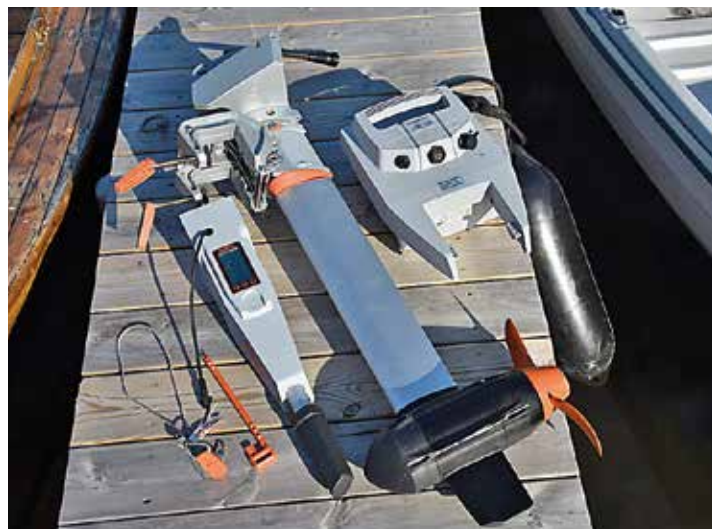
Hela paketet för en Torqeedo Travel 1103 C. Från vänster dödmansgrepp med magnet, sprint till batteriet, rigg och batteri.
