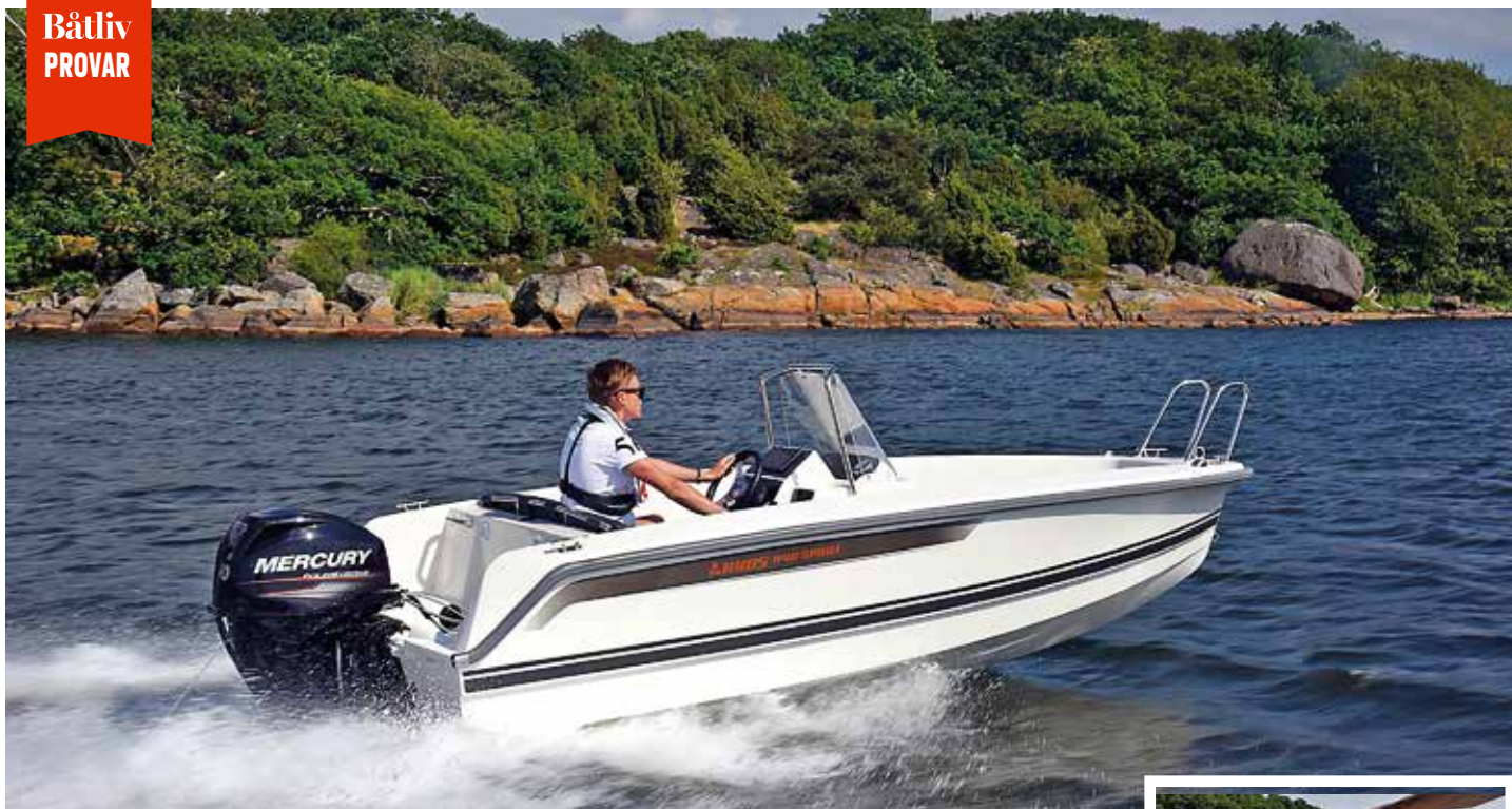
Fördäcket på Ryds 448 Sport har två stadiga räcken samt smart placering av lanternorna och låsöglan.
