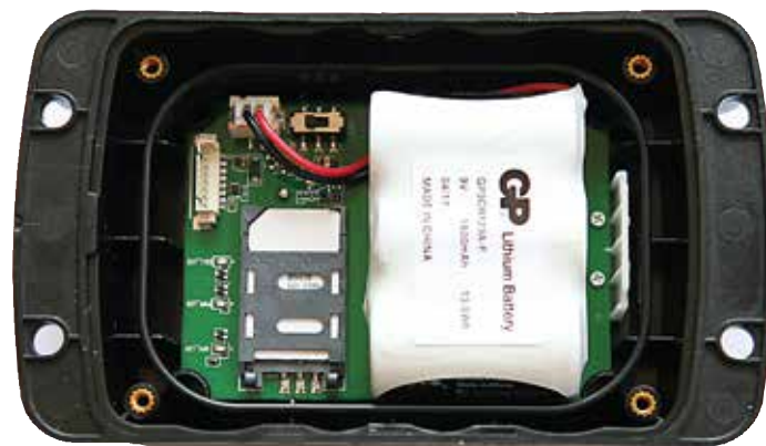
Huvudenheterna bli allt mindre och innehåller antenn, SIM-kort, batteri mm. Så här ser innanmätet ut i C-Pod Lite och NorthTracker Scout.
