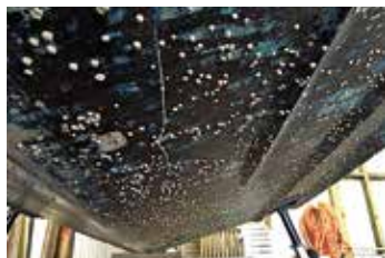
Före. Den gamla bottenfärgen har slutat att verka efter fem säsonger.
