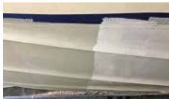
Olika kulörer på epoxiprimern gör det lättare att se var man målat det nya färgskiktet.
