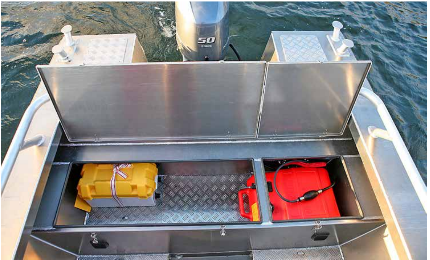
Akterfack med batteri och tank under separata luckor. I fördjupningen i durken samlas vatten som förs vidare till en elektrisk pump.
