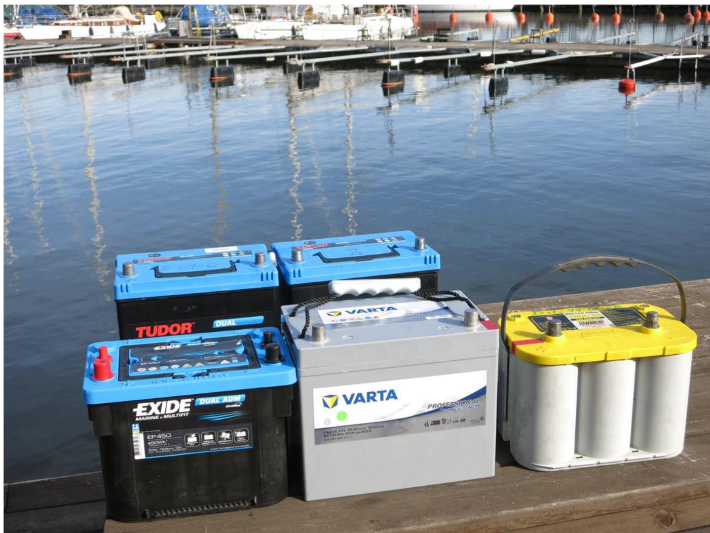
Batteribanken består av ett Varta LAD85, ett Exide EP450 samt två Tudor TR 350. Startbatteriet är ett Optima. Egenskaper enligt text. CTEC M300 laddare, 25 A.
